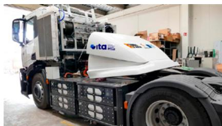
Planta piloto de generación de hidrógeno verde y cabeza tractora para transporte pesado con pila de hidrógeno.
