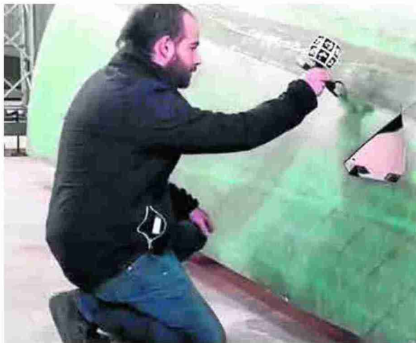
Un operario de Aitiip mediante cámara de visión artificial marca donde el robot ha de cortar (desmontaje de aviones). CENTRO AITIIP
