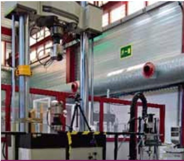
Máquina universal de ensayos biaxial.
